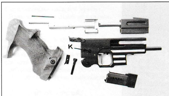
Le Pardini HP est ici sommairement démonté, comme pour procéder à un entretien de routine; la carcasse est percée («K») pour laisser voir le cran d'armé chien/gâchette. On remarquera que la crosse est ôtée sans dérèglement de l'appui-paume: le gros écrou cylindrique de ce réglage est percé et la vis d'assemblage passe au travers!
