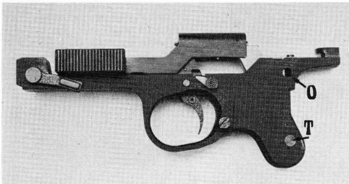
Sur la carcasse sont montés : la culasse, la rampe d'alimentation, l'arrière de culasse, la platine de détente, l'axe transversal pour la fixation de la crosse («T»). En «O», le trou pratiqué dans la carcasse pour surveiller la bonne action de la barrette de séparation (de l'autre côté !).
