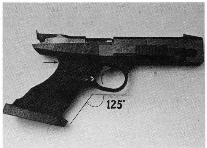
Le pistolet FAS «CF 603», calibre .32 S&W Wadcutter: 1270 gr. Dimensions: 287 x 140 x 48. Afin de ne pas être exagérément lourd, ce modèle est raccourci d'un cm par rapport au SP 602 de calibre .22. L'axe du centre de gravité est à 48 mm à l'avant de l'appui du majeur (étoile). Comme la pente de crosse est assez prononcée, cela fait un pistolet plutôt «lourd devant». L'axe du canon passe à 30 mm au-dessus de la fourche d'appui du pouce et de l'index, tandis que celui du ressort récupérateur (donc du «recul») est à 12 mm seulement. L'arme est livrée avec 2 chargeurs, 4 clés «Allen», 1 amortisseur en nylon et 1 percuteur de rechange.
